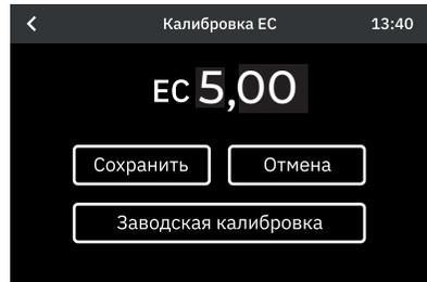
Калибровка датчика ЕС (см. «**Главный экран — стр. 27**») производится по двум точкам. На экранах калибровки есть счётчики для ввода значений ЕС калибровочных растворов.
