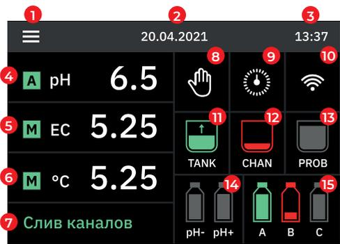
4 Область отображения pH, состояния регулятора pH, кнопка перехода к настройкам регулятора pH.
